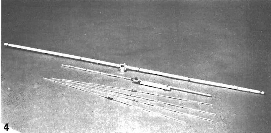
1 - Particolare dell'antenna: gamma-match per l'adattamento di impedenza.
